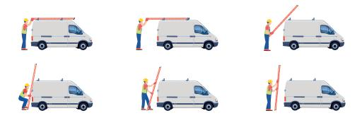
Coger la escalera y posicionarla encima del hombro lo más centrada posible, sujetándola firmemente con ambas manos, una en la estructura lateral y otra en un peldaño. Comprobar que se mantiene equilibrada para su desplazamiento, manteniéndola ligeramente inclinada con la parte delantera baja.
